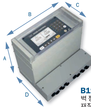
S19-42 벽 장착 하우징 (IP65) 재질 : 스테인레스 스틸 1.4301 / SS304 A: 301 mm (11.9 인치) B: 340 mm (13.4 인치) C: 237 mm (9.4 인치)
