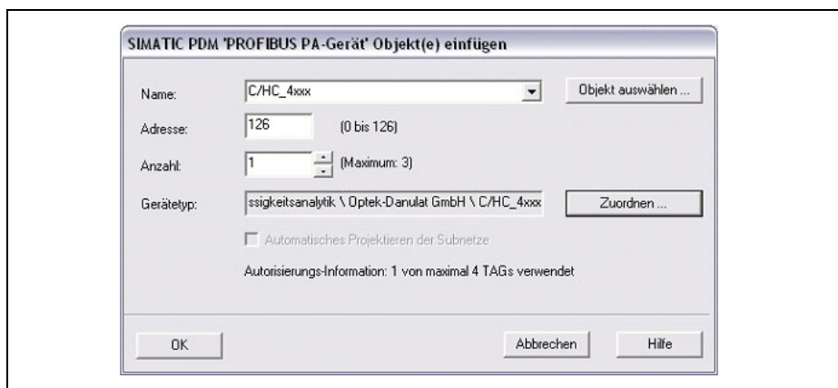
Рис. 20 Добавить устройство SIMATIC® PDM – PROFIBUS-PA
