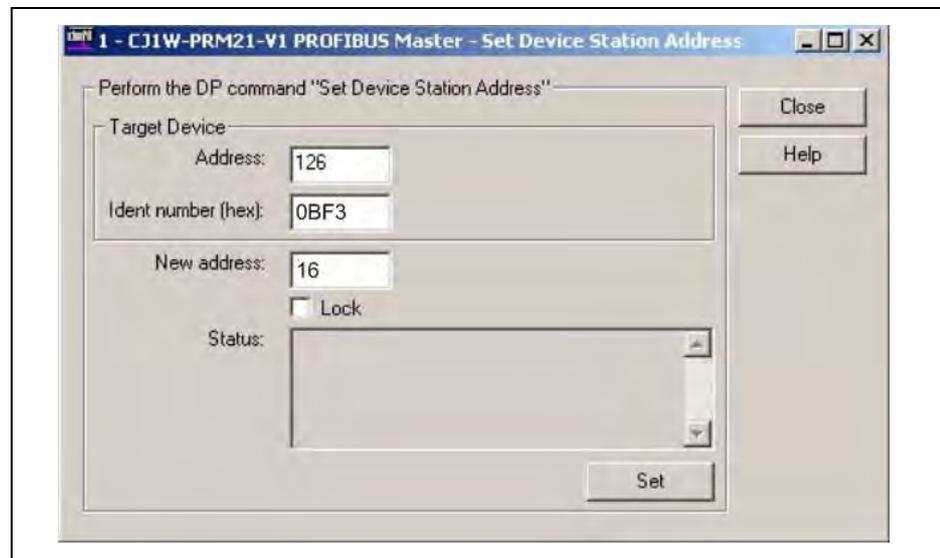
Abb. 14 Adressierung mittels Omron CS1/CJ1W-PRM21 Profibus Master Unit
