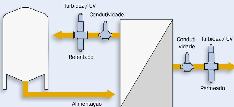
Em um processo típico de UF, dois pontos de instalação são usualmente considerados.
