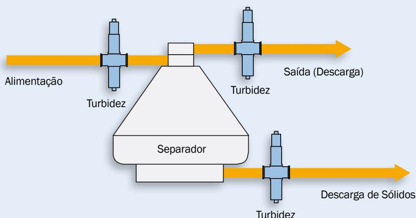
Quando instalado na entrada e saída da centrífuga, os fotômetros em linha da optek, tem provado melhorar substancialmente o desempenho da separação, reduzindo perdas bem como melhorando a consistência do produto.
