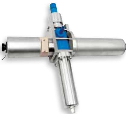
Vollständig montierte SUC27 für Leitfähigkeits-, pH-, UV- und Temperaturmessung
